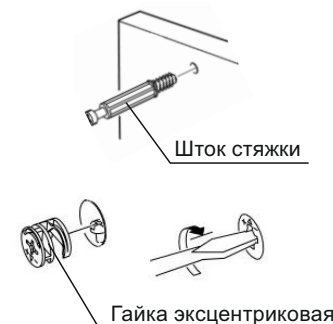
Схема 4. Установка стяжки эксцентриковой
