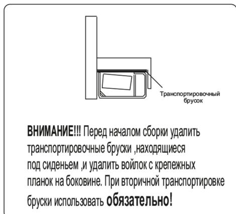
**ВНИМАНИЕ!!!** Перед началом сборки удалить транспортировочные бруски ,находящиеся под сиденьем ,и удалить войлок с крепежных планок на боковине. При вторичной транспортировке бруски использовать **обязательно!**
