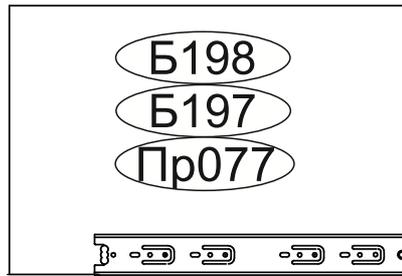
Для усиления прикрутить шуруп 4x16 в крайнее от переднего торца отверстие
