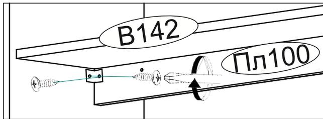
Если рядом с ЦС-04 будет установлен другой модуль, для предотвращения смещения планок Пл100 крайние уголки следует крепить к боковине соседнего модуля с одной стороны и Б196 с другой
